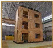
CLTを利用した建築物の実大振動台実験
