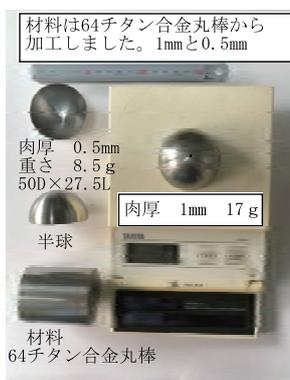
材料は64チタン合金丸棒から加工しました。1mmと0.5mm
