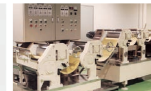
麺を伸ばし自動で切る「圧延・切出機」。
